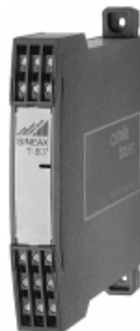
Bild 2. SINEAX TI 807-1 mit zwei oder drei Trenn- und Übertragungskanälen, im Gehäuse S17 , mit herausgezogenen Laschen für direkte Wandmontage.
